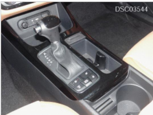
2. 使用螺丝刀或拆卸工具拆卸控制台上盖(A)。
